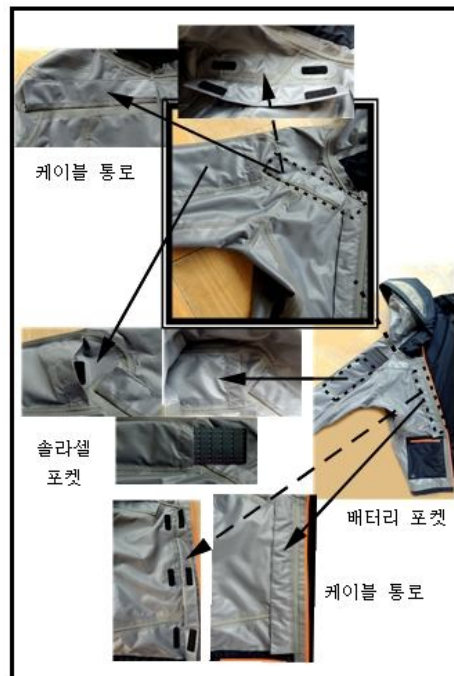
Fig. 4. 솔라셀 내장 SYSTEM- 포켓, 케이블통로
