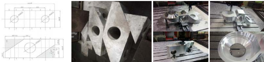
Fig.3 경량 액슬박스 제작 - 단조 및 가공
